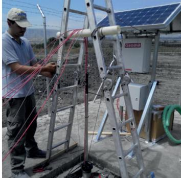
Installation de l'inclino-extensomètre DEX-S, Mine de Chuquicamata, Chile
