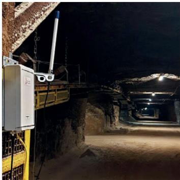
Installation inclin-extensomètre DEX-S, 150 mt de profondeur, dans la mine Ptolemaida, Grèce
